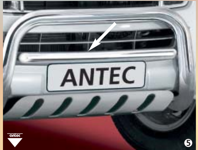
EU-pipe 42mm (upper) EU tverror øppe 42 mm Stainless steel/ Edelstål 193 4041
